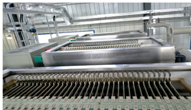
图 5 应用亚氧化钛电极的大型污水处理装置
