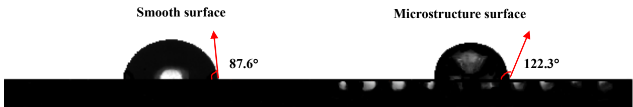
图5 水滴与铝合金表面的接触角
