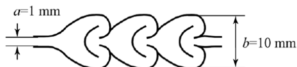
图1 微反应器结构 Fig.1 Microreactor structure
